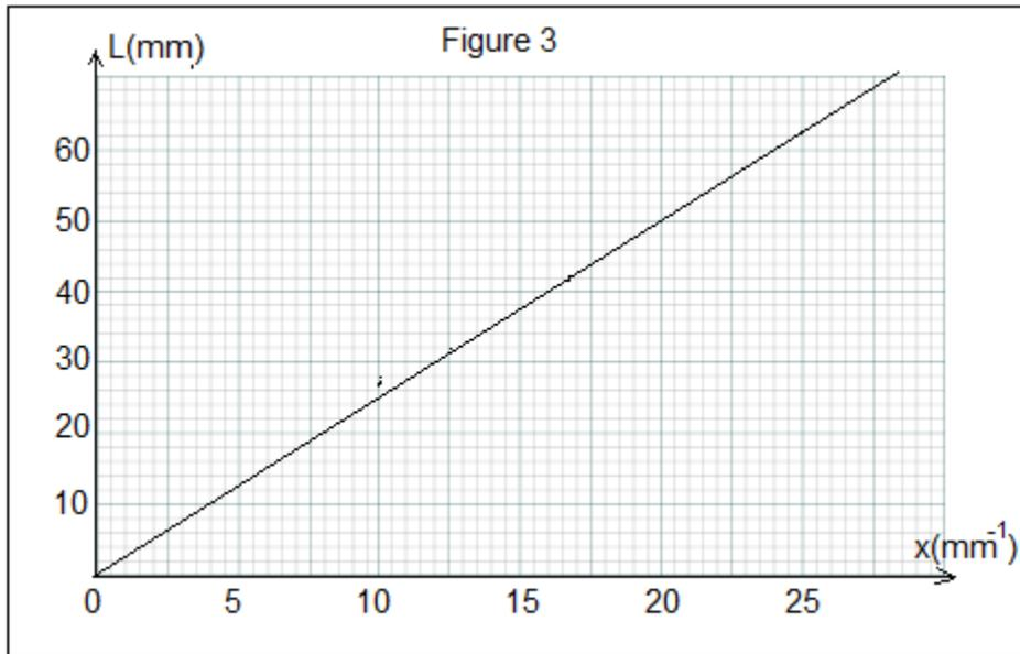
10- Donner l'équation de la courbe  $L = f(x)$  et en déduire la longueur d'onde  $\lambda$  (en m puis en nm) dans le vide de la lumière monochromatique de la source laser.
