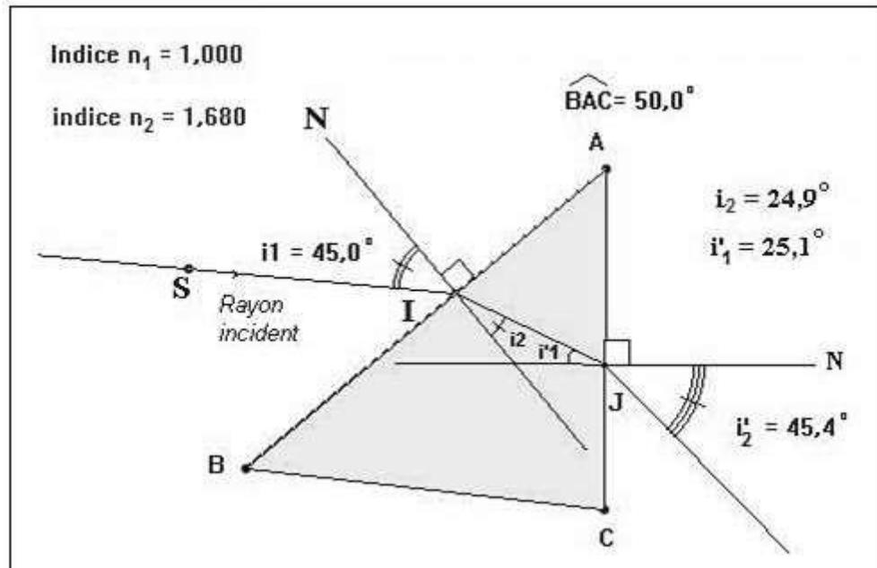
On envoie sur une face du prisme d'angle  $A = 50^\circ$  un mince faisceau de lumière blanche d'indice  $i_1 = 45^\circ$ .
