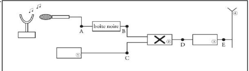
Dispositifs électroniques : antenne, amplificateur HF (haute fréquence), générateur HF (haute fréquence), multiplieur, voltmètre.
