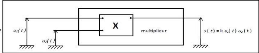
1. Ce montage délivre une tension de sortie  $s(t)$  telle que  $s(t) = k \cdot u_1(t) \cdot u_2(t)$ , où  $k$  est un coefficient caractéristique du multiplieur.
